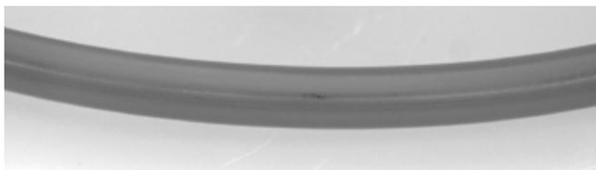
Bei der Qualitätsprüfung von O-Ringen spielt die Parting Line am Innen- und Außendurchmesser eine wichtige Rolle. Hier treten häufig Defekte wie z.B. Grat, Einkerbungen, Einzugstellen oder raue Flächen auf, die durch Werkzeugtrennung, Beschädigungen der Werkzeugkante oder bei der Entgratung entstehen.
