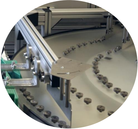
Teileschonende Zuführung über einen Drehtisch
