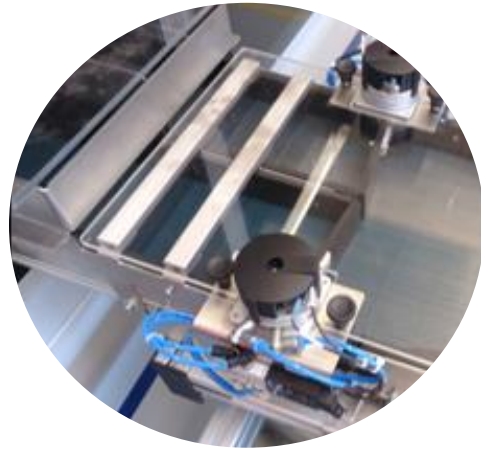
Bauteilsortierung über zweibahniges Band
