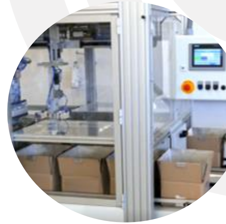
Sortierung mittels Setzpacker
