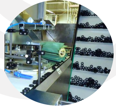
Steigförderer mit Bauteilvereinzlung und -rückführung
