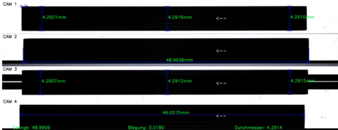
Mit dem Glasrutschensystem von NELA werden längliche bzw. zylindrische Serienteile auf verschiedene Merkmale wie z.B. Durchmesser, Länge, Höhe oder Biegung geprüft.
